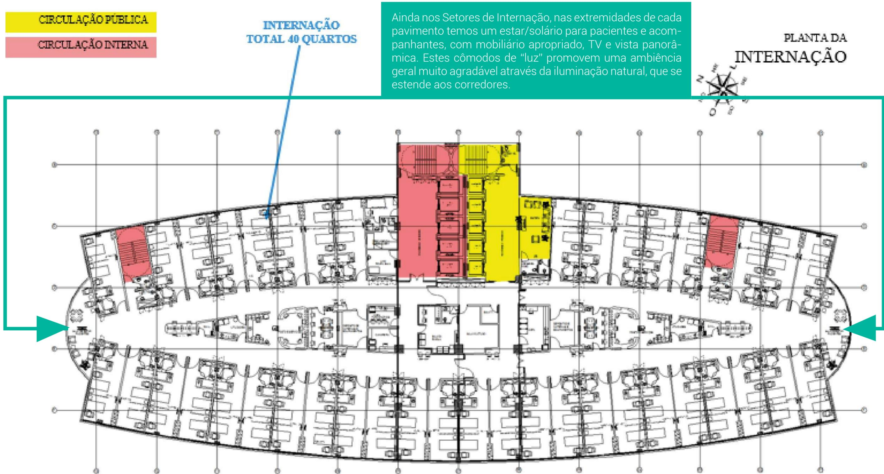
Figura 9: Planta pavimento de internação com enfermarias de 2 leitos e solários nas extremidades, HMDCC, Belo Horizonte, 2017.
